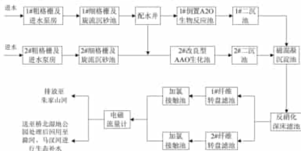
图 4-2 盘城污水处理厂工艺流程图
