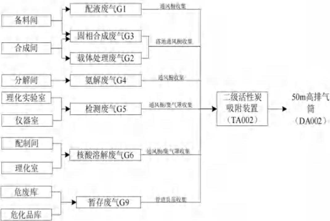
图 4-1 本项目废气治理工艺流程图
